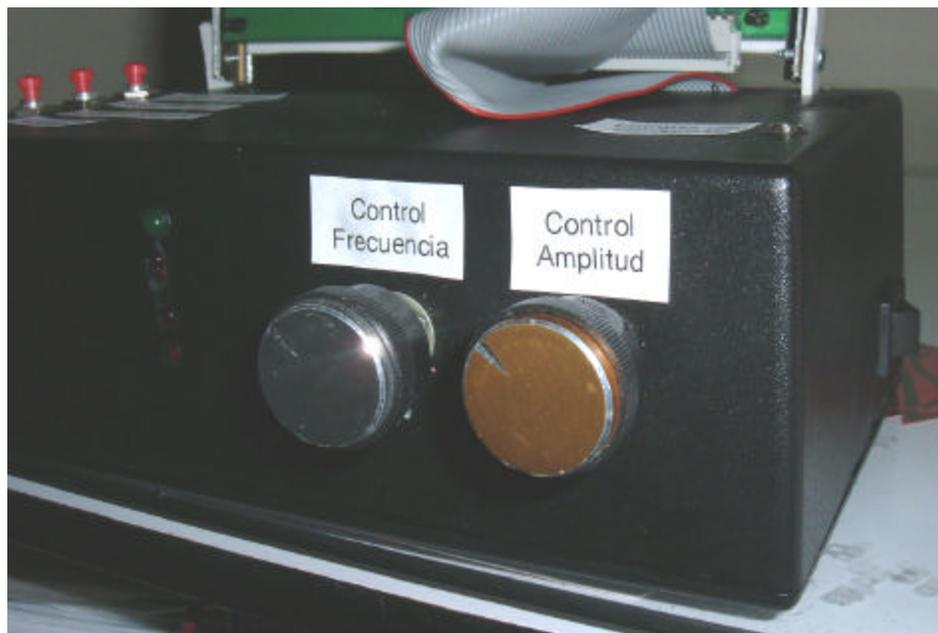
**Figura 85.** Selectores de amplitud y frecuencia
