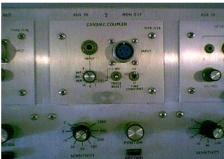
**Figura 22.** Canal de registro electrocardiográfico
