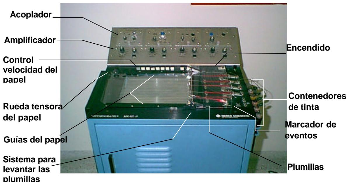
**Figura 19.** Fisiógrafo Tipo MK-III-P de Narco Scientific BIO-Systems Divisions
