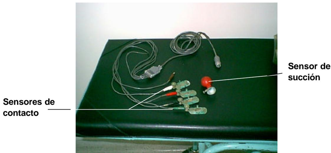
**Figura 21.** Electrodo para el módulo ECG
