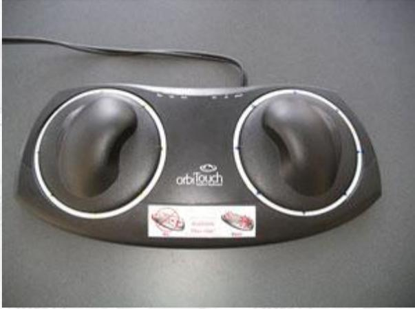
خيل أن حاسبك الشخصي متصل بلوحة مفاتيح ولكنها .... بدون مفاتيح !!! نعم، فلوحة المفاتيح الجديدة **Keyless Keyboard OrbiTouch** يمكن استخدامها للتعامل مع الحاسب الشخصي ولكن دون أن تحتوي على أي مفاتيح. فهذه اللوحة تستبعد أي استخدام للأصابع مما يقلل من حركة المعصم وبالتالي يقلل من أي الآم في الذراعين والرقبة يمكن أن تنتج من الاستخدام المتكرر والطويل للحاسب. وتتصل هذه اللوحة بالحاسب من خلال وصلة **PS/2** وهي تقوم بوظيفة لوحة المفاتيح والفأرة في نفس الوقت. وتحتوي لوحة
